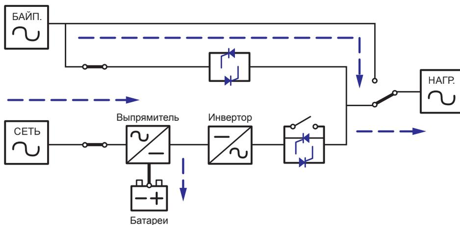
Рис. 4-5. Передача электроэнергии через ИБП в режиме байпаса
