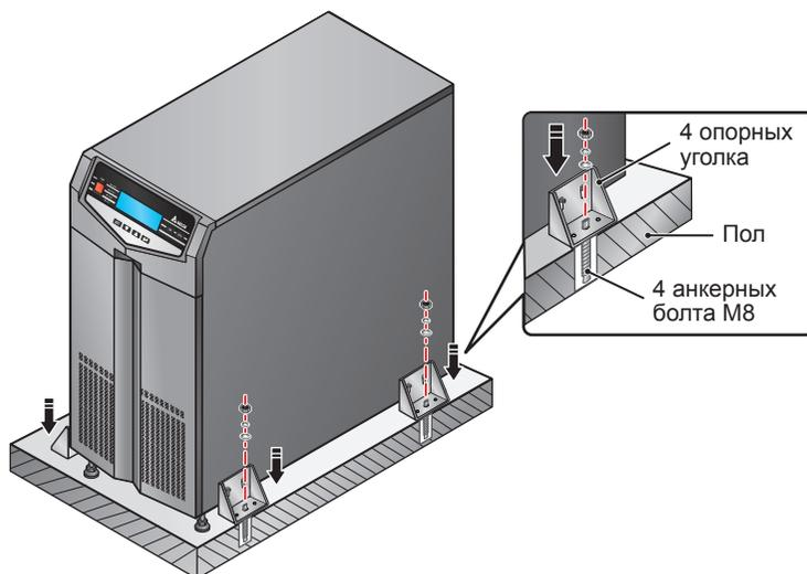
Рис. 6-4. Крепление опорных уголков к полу
