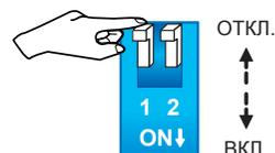
Рис. 5-2. Переключатель параллели
