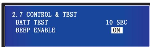
1. **BATT TEST:** Разрешить или отменить выполнение теста АКБ. Возможен выбор из трёх вариантов: **ABORT** (прервать), **DEEP** (глубокий) или **10 SEC** (10 секунд).
