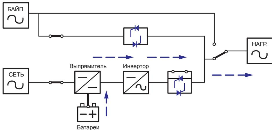
Рис. 4-4. Передача электроэнергии через ИБП в автономном режиме
