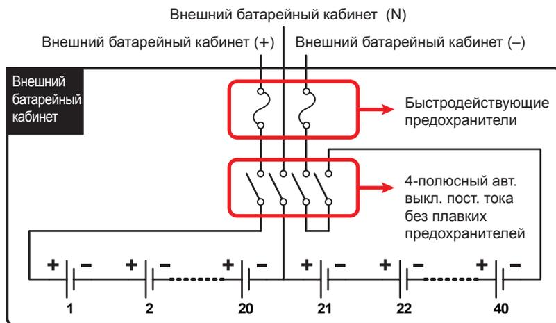
*Рис. 6-19. Подключение внешнего батарейного кабинета сторонних производителей*
