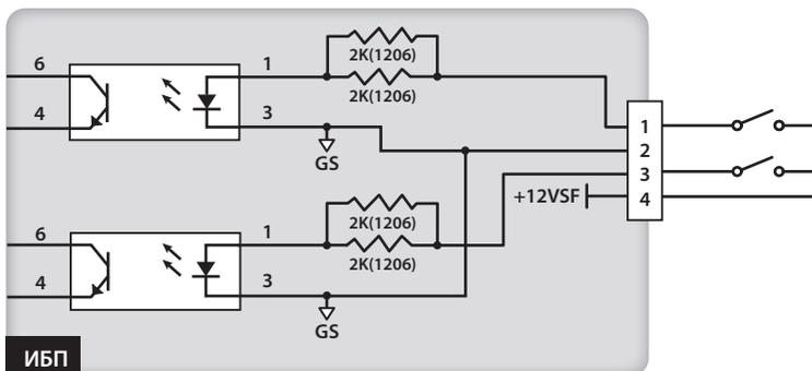
Рис. 5-6. Входные сухие контакты: конфигурация I
