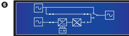
ИБП в режиме ручного байпаса. В этот режим ИБП следует переключить перед техническим обслуживанием, чтобы отсоединить его от электросети и батарей. В этом режиме нагрузки не защищены. При исчезновении переменного напряжения на входе байпаса они будут обесточены.
