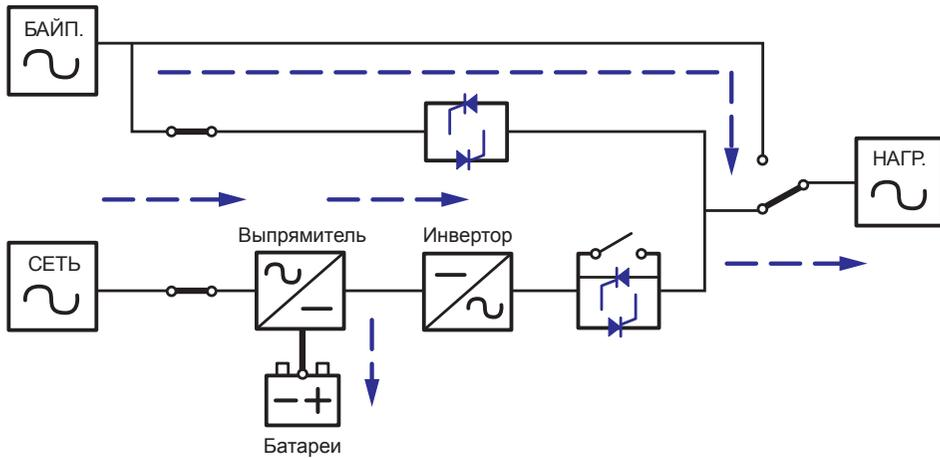
Рис. 4-3. Передача электроэнергии через ИБП в экономичном режиме
