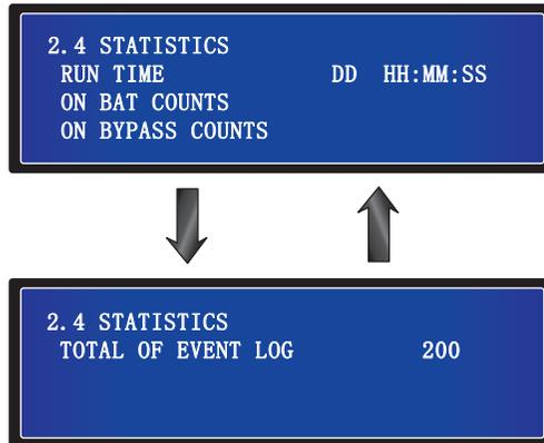
1. **RUN TIME (DD HH: MM: SS)**: Общее время работы ИБП (ДД ЧЧ: ММ: СС).
