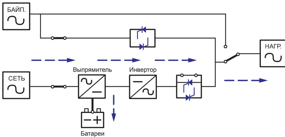
Рис. 4-1. Передача электроэнергии через ИБП в нормальном режиме
