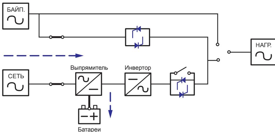
Рис. 4-2. Передача электроэнергии через ИБП в режиме готовности
