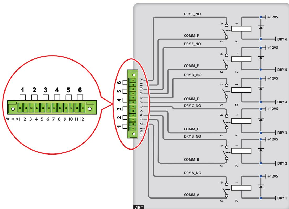
Рис. 5-4. Выходные сухие контакты: назначение и подключение выводов
