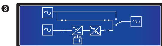
ИБП в режиме байпаса. Сетевой вход и батареи отключены. В этом режиме нагрузки не защищены. При исчезновении переменного напряжения на входе байпаса они будут обесточены.
