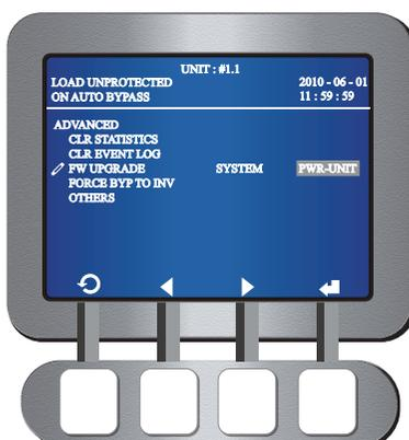
Если вы выбрали **СИСТЕМА**, то ИБП обновит микропрограммное обеспечение системы. Если вы выбрали **СИЛ. БЛОК**, то ИБП обновит микропрограммное обеспечение силового блока. После того, как было выбрано **СИЛ. БЛОК**, последовательно появятся следующие экраны.
